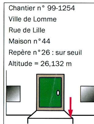
Figure 370. Croquis de repérage d'une station de lever
